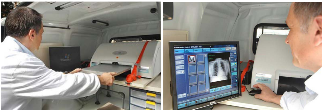
Fig. 4 - Carestream – Point of care 260 – monitor, c.r. e cassette ai fosfori – in basso modalità operativa di utilizzo.
