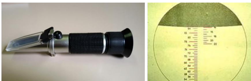
Fig. 51 - Réfractomètre à miel (à gauche) et exemple de mensuration (à droite). L'échelle à droite indique le pourcentage d'eau, celle à gauche le pourcentage de sucres.
