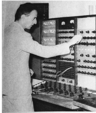
Marinuzzi alle prese con il «Fonosynth», apparecchiatura per la realizzazione di musica elettronica costruito da Strini, Keteff e Marinuzzi stesso.
