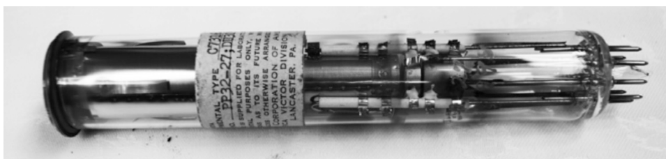
Fig. 4 Vidicon Tube, prototipo in sviluppo presso gli RCA Lab., fotografato il 15/5/2013, AIR.
