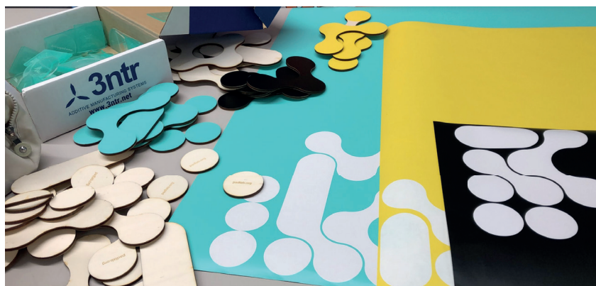
Fig. 4 – Realizzazione prototipo: tessere di forma organica e applicazione pellicola adesiva in vinile scrivibile (pellicola tagliata con vinil plotter presente in Fablab BITZ UNIBZ)
