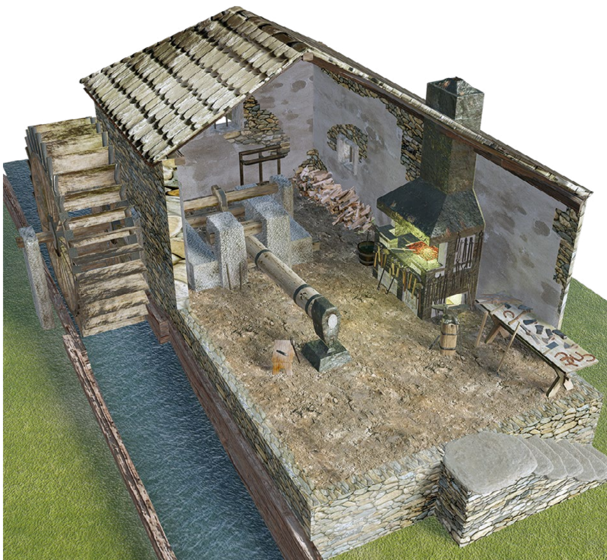
Figura 23. Ricostruzione di una fucina con un maglio a testa d'asino.
