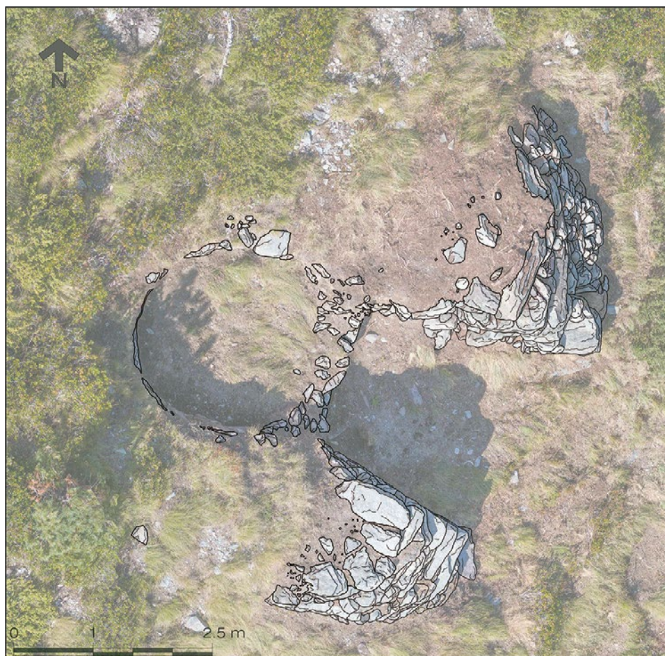
Figura 8. Fusine. Val Cervia. Forno di arrostitimento a Nord della miniera. Rilievo della struttura.
