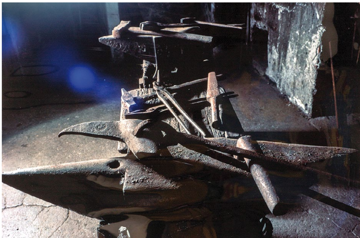
Figura 29. Fusine. Incudine bicornia con utensili originali della fucina Bazzi.
