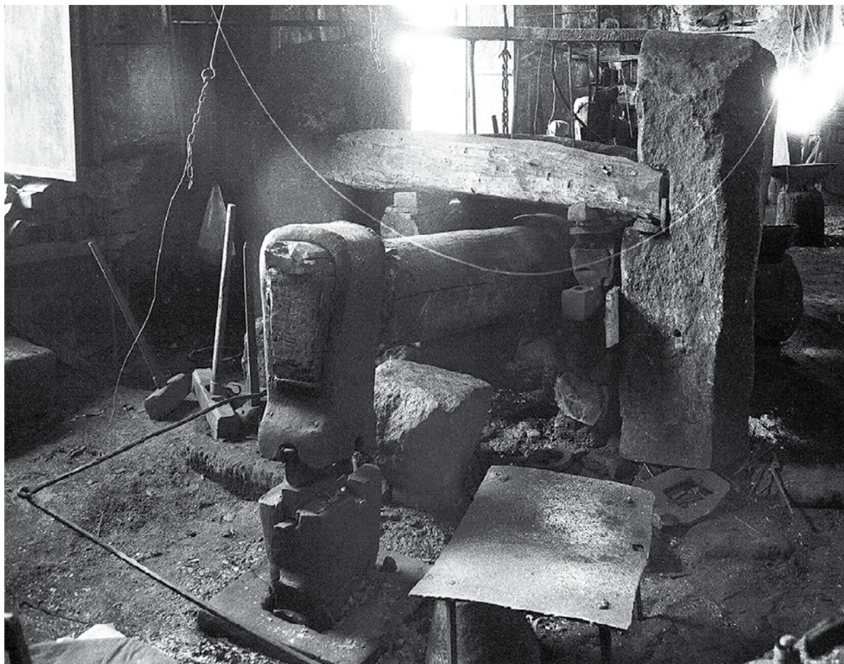
Figura 27. Particolare di un maglio della Valcamonica e della sua struttura di funzionamento (foto Roberto Predali).
