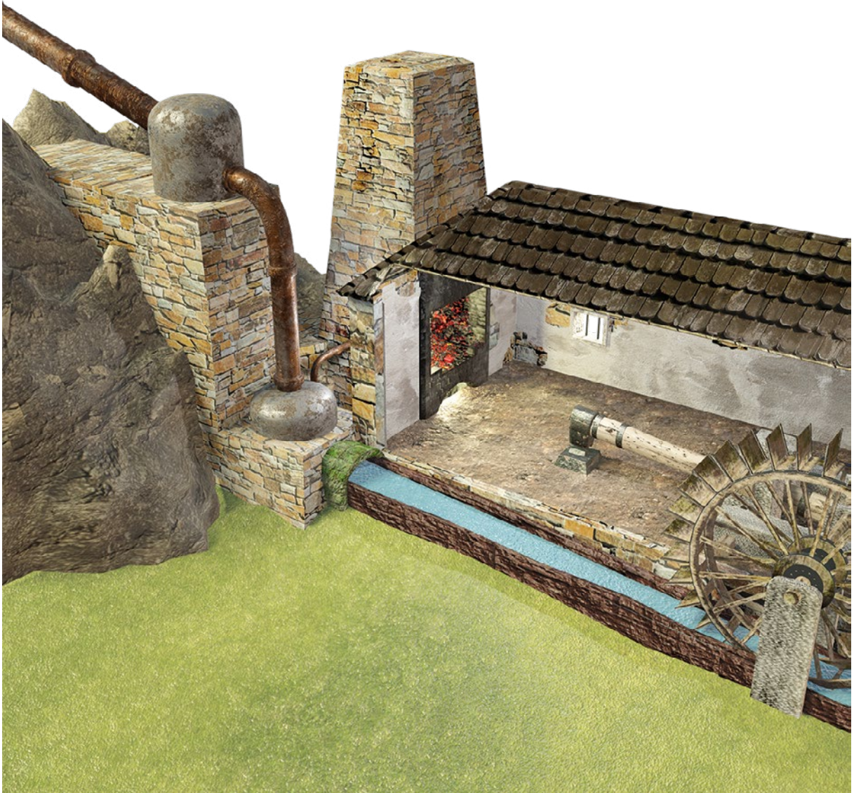
Figura 28. Ricostruzione di una tromba idroeolica e dello spazio di lavoro interno di una fucina.
